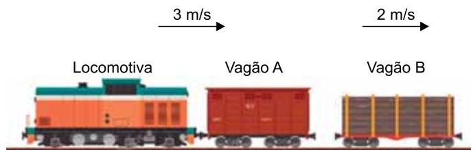
Sabendo que as massas dos vagões A e B são  $m_A = m_B = 2 \times 10^4 \text{ kg}$  e que imediatamente após a colisão o conjunto formado pela locomotiva e pelos dois vagões se move com velocidade 2,8 m/s, a massa  $M$  da locomotiva é
