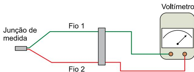
Como esses fios são constituídos de metais diferentes, o voltímetro indica uma diferença de potencial que depende da temperatura lida pela junção de medida. Essa diferença de potencial é interpretada e determina a temperatura lida pelo termopar.
