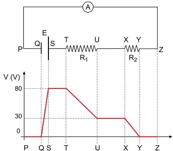
Sabendo que o amperímetro indica 2 A, as resistências  $R_1$  e  $R_2$  são, respectivamente, iguais a
